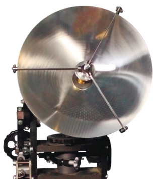
Зеркальная антенная система ЗА5-0,4 в сборе с облучающей системой ОС-2/Л на координатном устройстве с ручным управлением.
