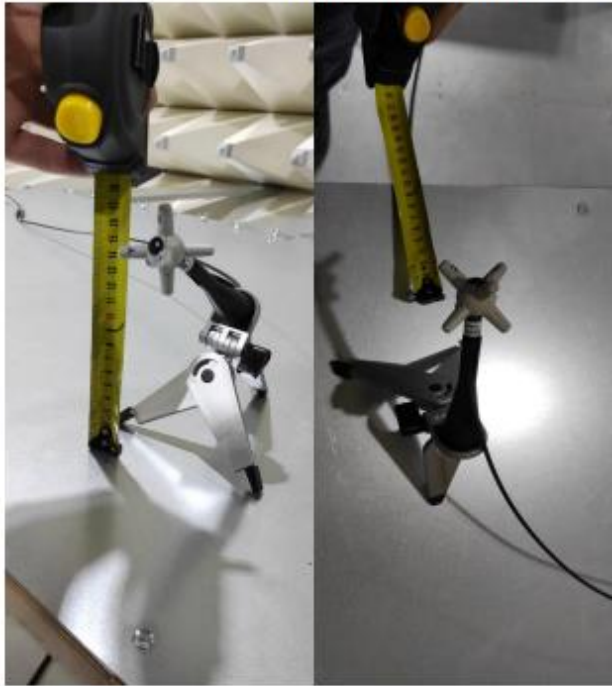
Рисунок 6. Установка датчиков поля
