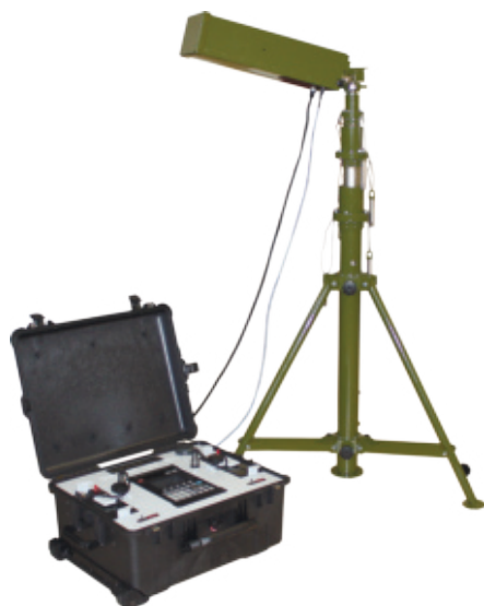
На фото: Хамелеон-П в комплектации с антенно-усилительным модулем диапазона 6 - 18 ГГц
