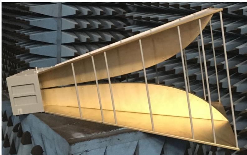
Рисунок 1 – Общий вид антенны П6-160
