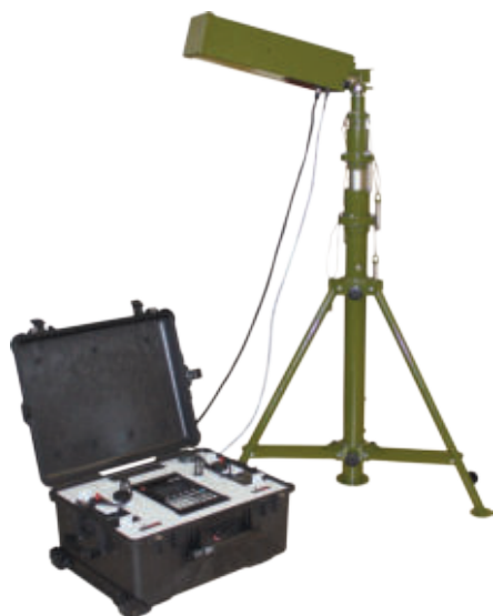
На фото: Хамелеон-П в комплектации с антенно-усилительным модулем диапазона 6 - 18 ГГц
