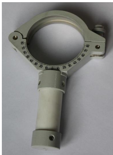
Рисунок 3 – Общий вид кронштейна АК-02 для крепления рупора КНПР.301421.004
