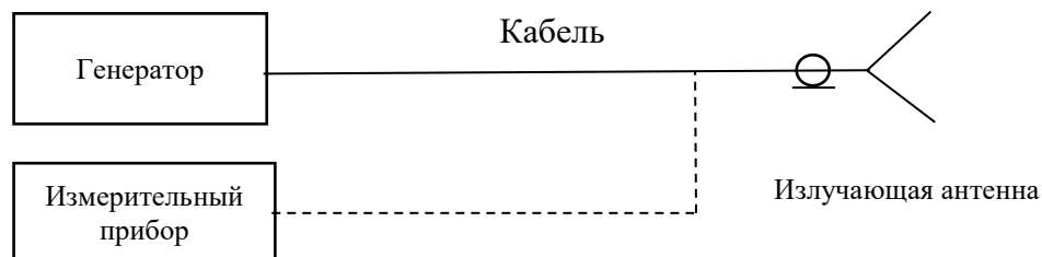
Рисунок 7 – Схема соединения приборов для создания электромагнитного поля с заданной плотностью потока энергии.
