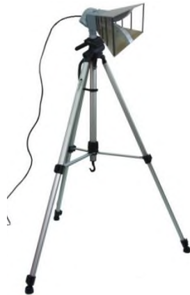
Рисунок 2 – Внешний вид П6-123 в развёрнутом положении
