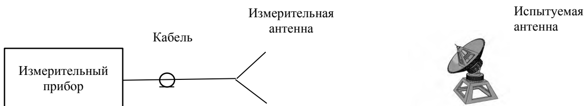
Рисунок 12 – Схема соединения приборов при измерении плотности потока энергии
