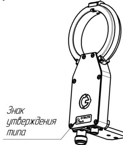
Рисунок 2 - Схема нанесения знака утверждения типа на антенну П6-219
